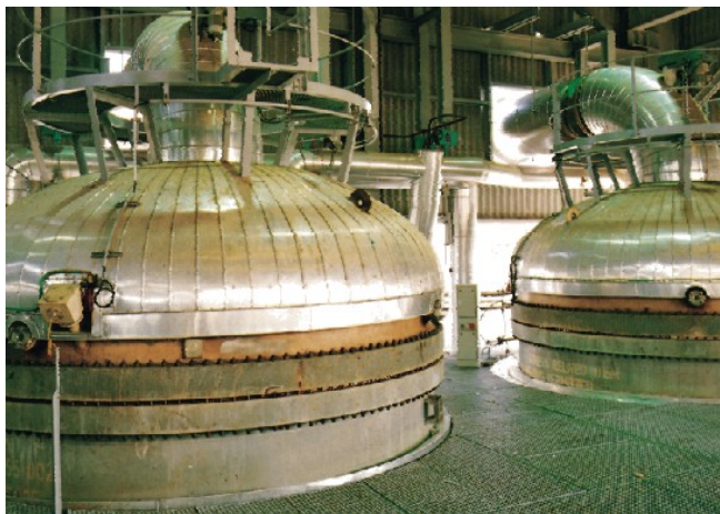
Obr. 4.4. Reaktory pro oxidaci 260 t amoniaku za den . Průměr 5 m.
