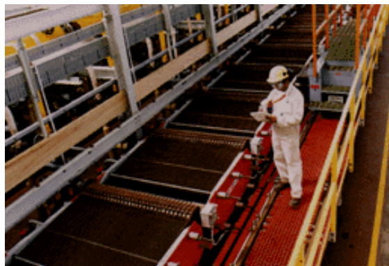
Obr. 7.2. Baterie membránových elektrolýzérů. Každý blok obsahuje asi 20 svislých membrán o ploše asi 1 \times 1 \text{ m}
