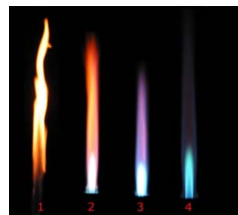
Obr. 12.1. Hoření plynu. Čadivý, svítivý „redukční“ plamen a horký, ostrý plamen plynu s postupně přimíchávaným kyslíkem
